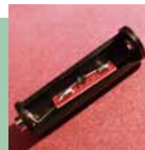
単3電池形ダミー電池 ダイオードタイプ各種 AABAT-D4002/SBD5817
